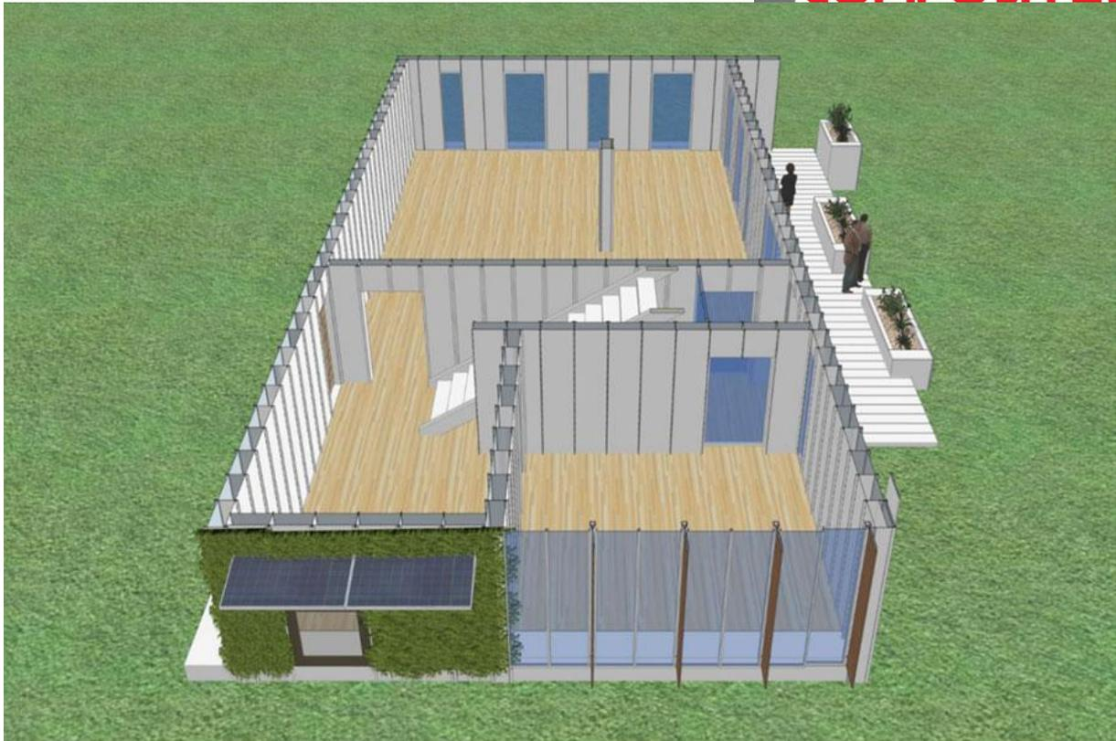
L'idée derrière Wall E+®, système constructif innovant de murs+façades, est d'exploiter les potentialités des matériaux composites dans le secteur du bâtiment qui les a ignorées jusqu'alors.
