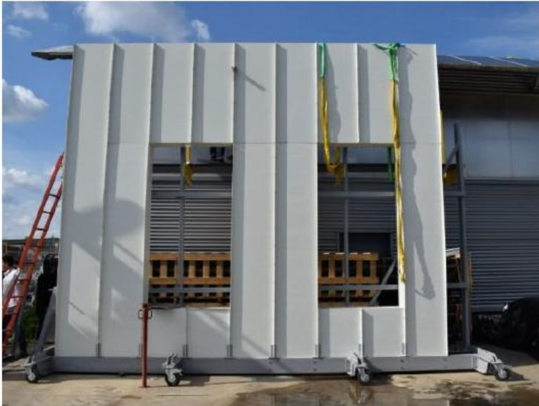
Système constructif avec matériaux composite © Solutions Composites
